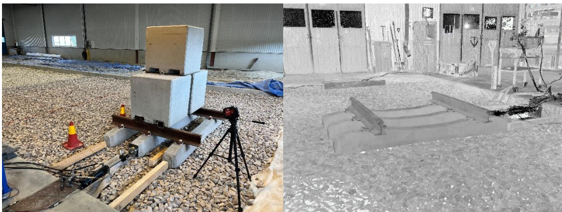
Figur 10. Testupställning i lastfall R4 med tre betongblock. Höger: Exempelbild från 3D-laserskanningens punktmoln.
