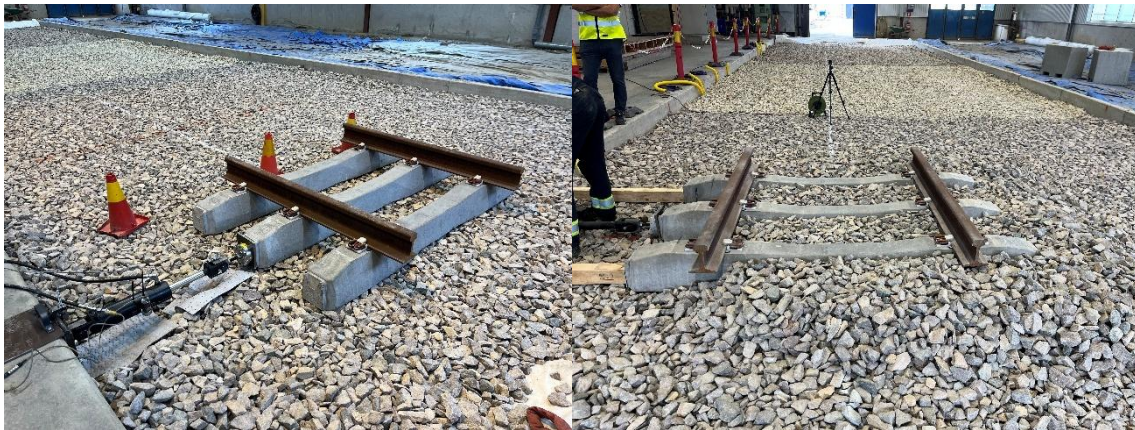
Figur 9. Exempelbild av den okonfinerade C1-konfigurationen. Höger: Exempelbild av den konfinerade C2-konfigurationen.
