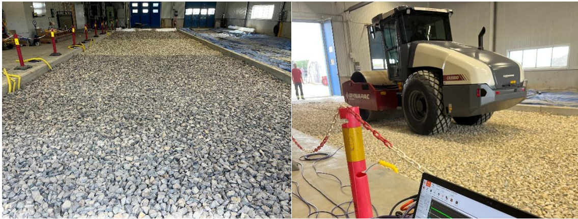
Figur 8. Kanal fylld med material M1–M3 före statisk packning. Höger: Under statisk packning med vält.
