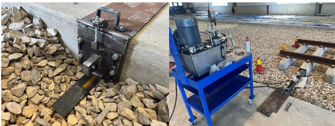
Figur 7. Den utvecklade uppställningen för att fixera och rikta den hydrauliska cylindern. Höger: Komplet systemuppställning med hydrauliksystem och sensorer.
