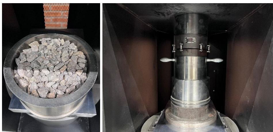
Figur 11. Foto av testcylindern med preparerat prov (vänster) samt under belastning i Instron 400RD (höger).
