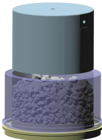
Figur 16. Oedometeruppställningen består av en cylindrisk behållare (lila), en bottenplugg (gul) och en kolv (blå). Cylindern är fylld med en partikelbädd (grå).
